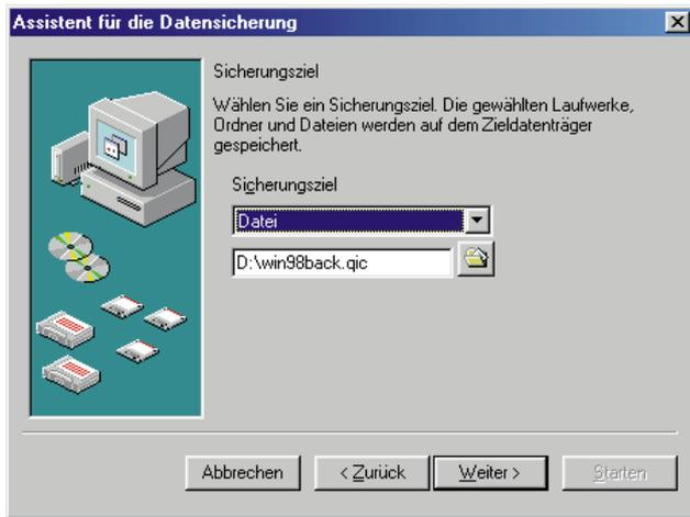
Das schnellste System-Komplett-Backup verwendet als Sicherungsmedium eine Datei, etwa auf einer anderen Partition oder Festplatte. Die etwa 150 MByte sind in wenigen Minuten gesichert.
