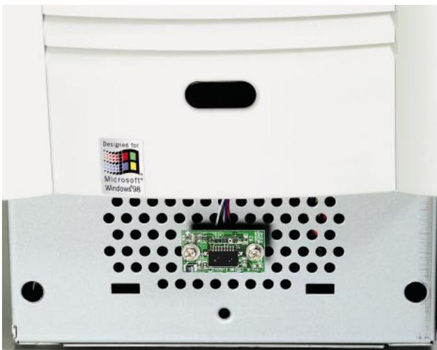
Ideal für den Datenaustausch mit Kleincomputern ist die nach außen geführte IrDA-Diode bei Packard Bell.
